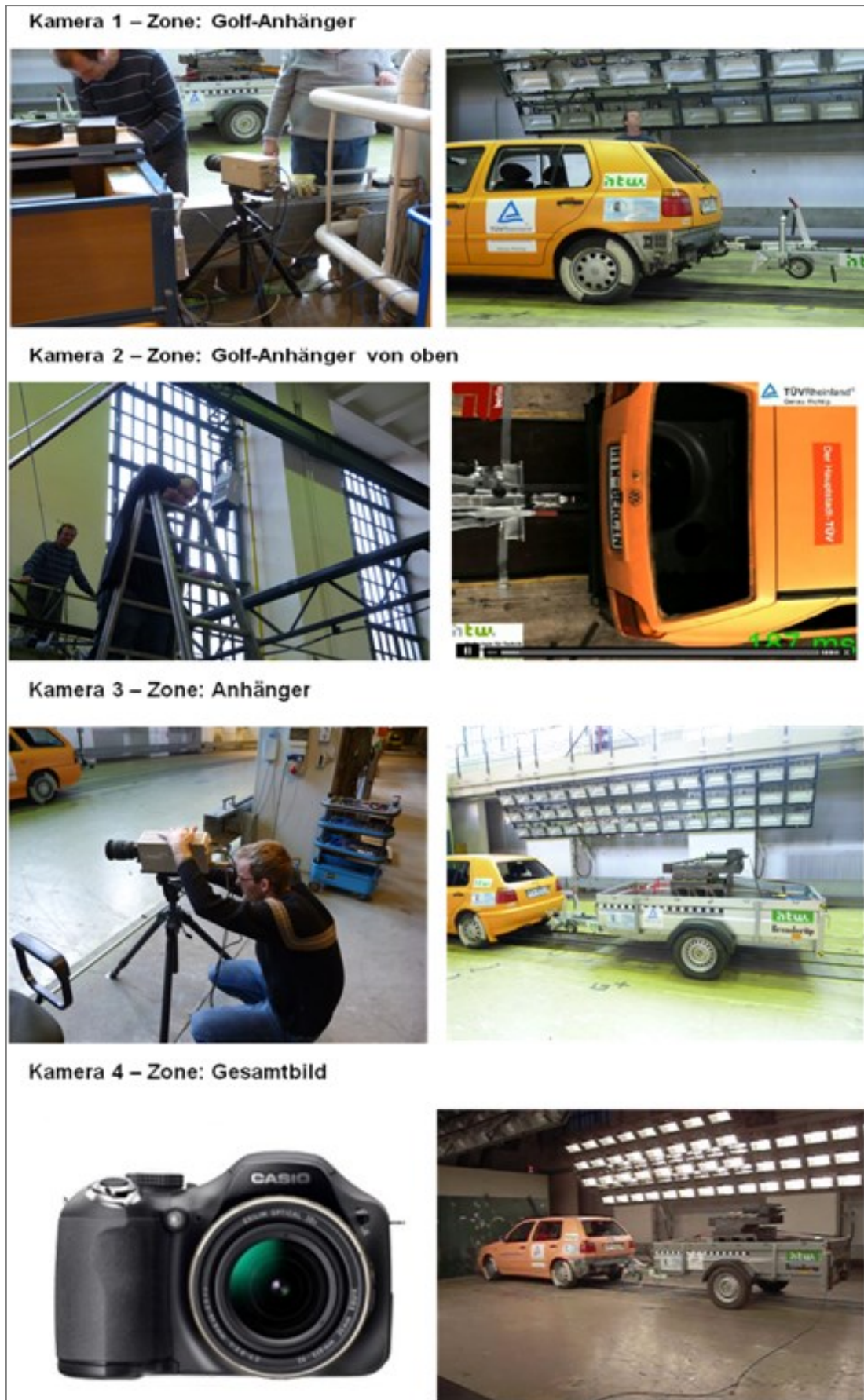
Abb. 6.10: Ausrichten der Kameras
