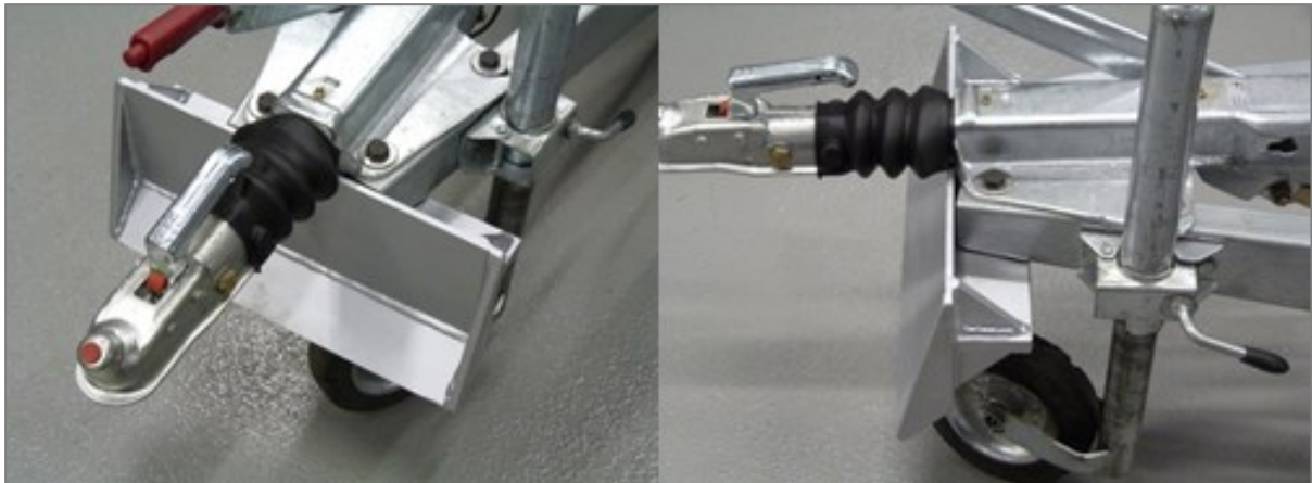
Abb. 5.5: Crashplatte – Vorder- und Seitenansicht
