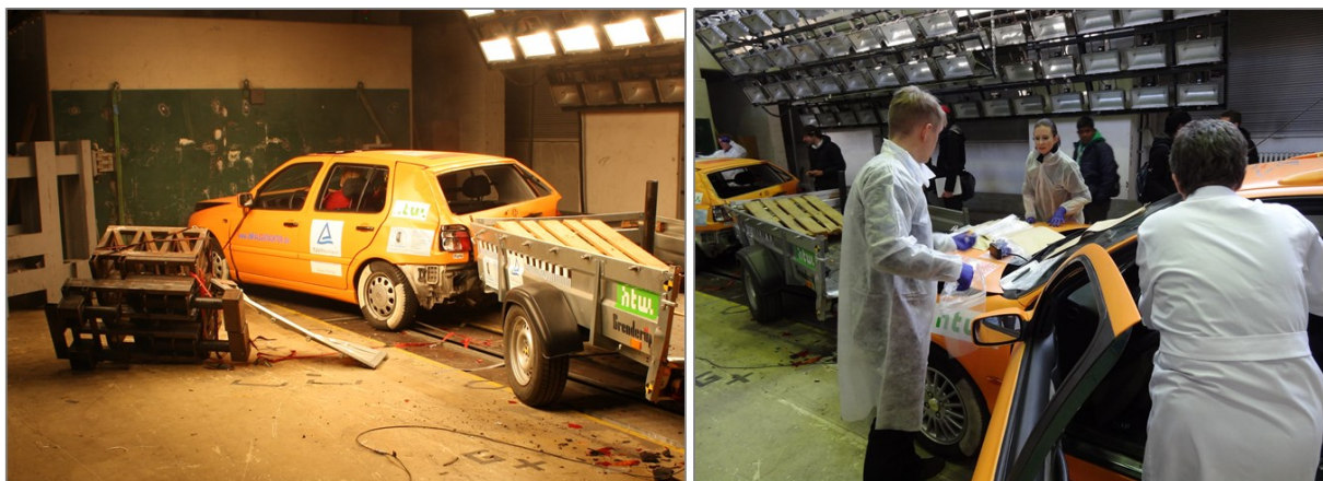
Abb. 7.4: Endlage der Ladung (li.), Spurensicherung (re.)
