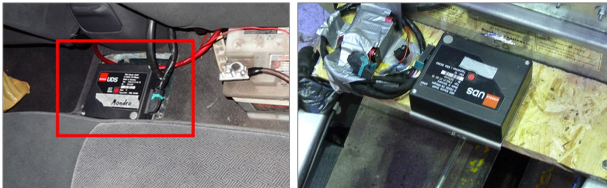
Abb. 5.12: UDS auf dem Mitteltunnel (li.), UDS am Anhänger mit Batteriepack (re.)
