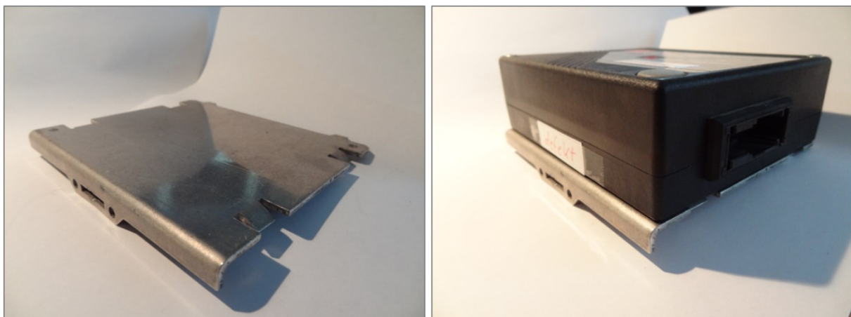
Abb. 5.11: Befestigungsplatte (li.), Befestigungsplatte mit UDS verschraubt (re.)
