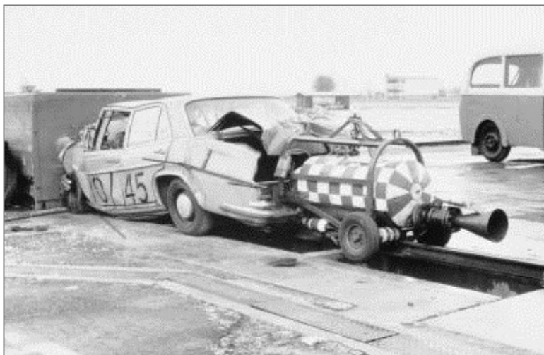
Abb. 3.4: Crashtest mit Heißwasserrakete als Antrieb [11]
