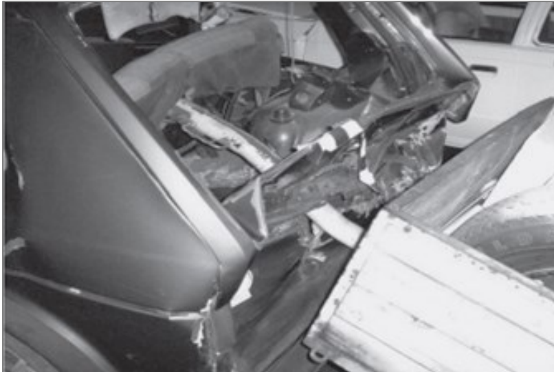
Abb. 3.11: Anhänger-Zugrohr im Fahrzeugheck[23]
